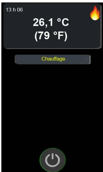
3. Le ventilateur d'extraction démarre et l'huile commence à chauffer à 178,9 °C (354 °F). L'écran affiche la température actuelle et une icône de flamme s'affiche pour indiquer que l'huile chauffe.
