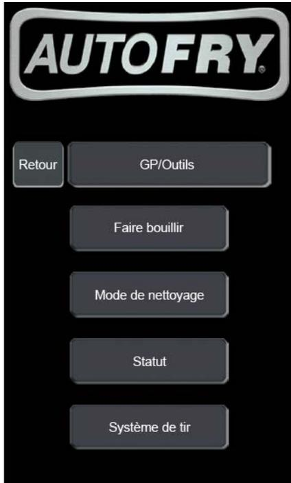
50. Le mode Le mode de nettoyage permet de retirer les débris du réservoir d'huile. La température de l'huile doit être supérieure à 121,1 °C (250 °F) pour accéder à cette fonction.
