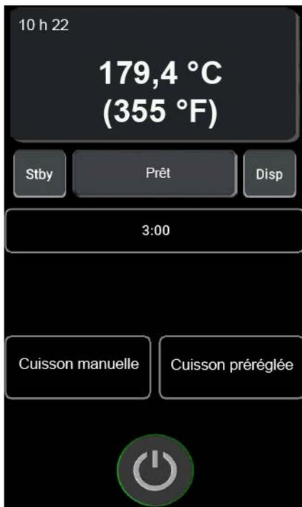
23. Le mode veille (Stby) est utilisé en dehors des heures de pointe pour économiser l'énergie et maximiser la durée de vie du pétrole.
