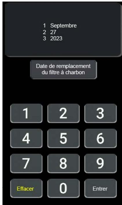
60. Appuyez sur la date de remplacement (Remplacé) Sous charbon (Charcoal) pour modifier la date du dernier remplacement du filtre à charbon.
