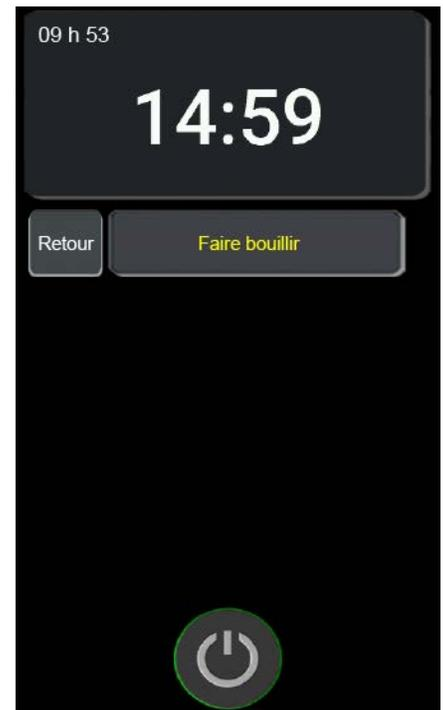
49. Lorsque la température atteint 90,6 °C (195 °F), la minuterie commence. Une fois le temps écoulé, le contrôle émet un bip et l'écran revient à l'écran OFF.
