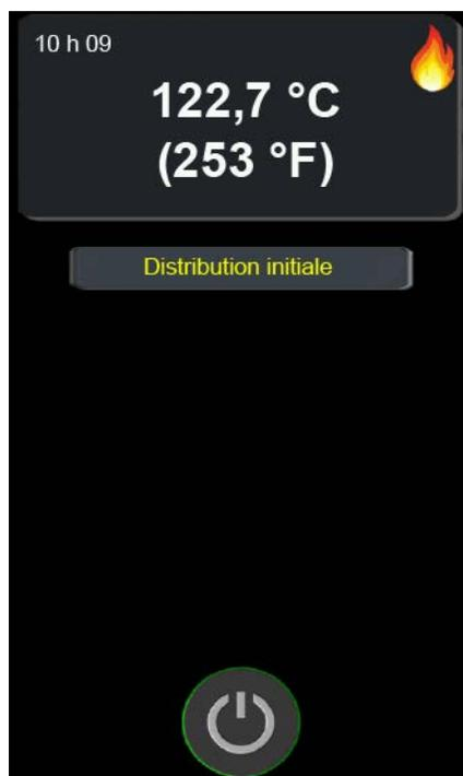
4. À 121,1 °C (250 °F), le panier effectue un cycle de test, puis reprend le chauffage. Vous entendrez les paniers frapper la paroi latérale de l'AutoFry. C'est normal.
