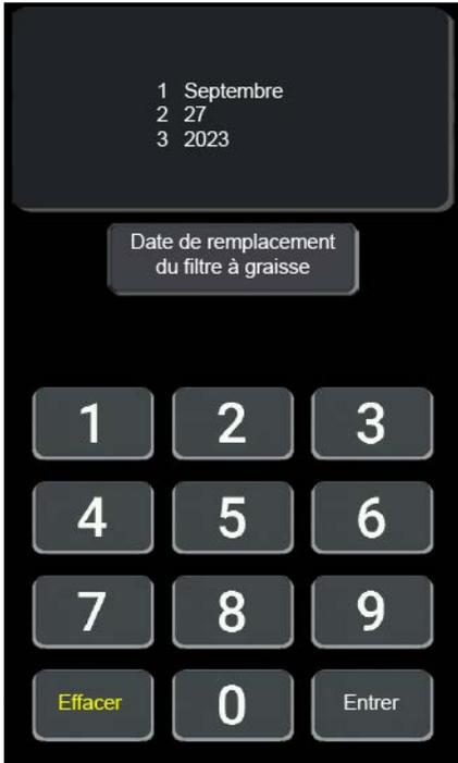
64. Appuyez sur la date de remplacement sous Grease pour modifier la date du dernier remplacement du déflecteur de graisse. Saisissez la date remplacée et appuyez sur Entrée pour enregistrer.
