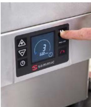
Le l'écran du SCP affiche la puissance du moteur en tout temps. Il est également possible de programmer une alarme sonore lorsque le moteur de l'appareil dépasse la puissance établie. Chaque produit est coupé de manière optimale et uniforme en tout temps, offrant à l'utilisateur la coupe de produit souhaitée.
